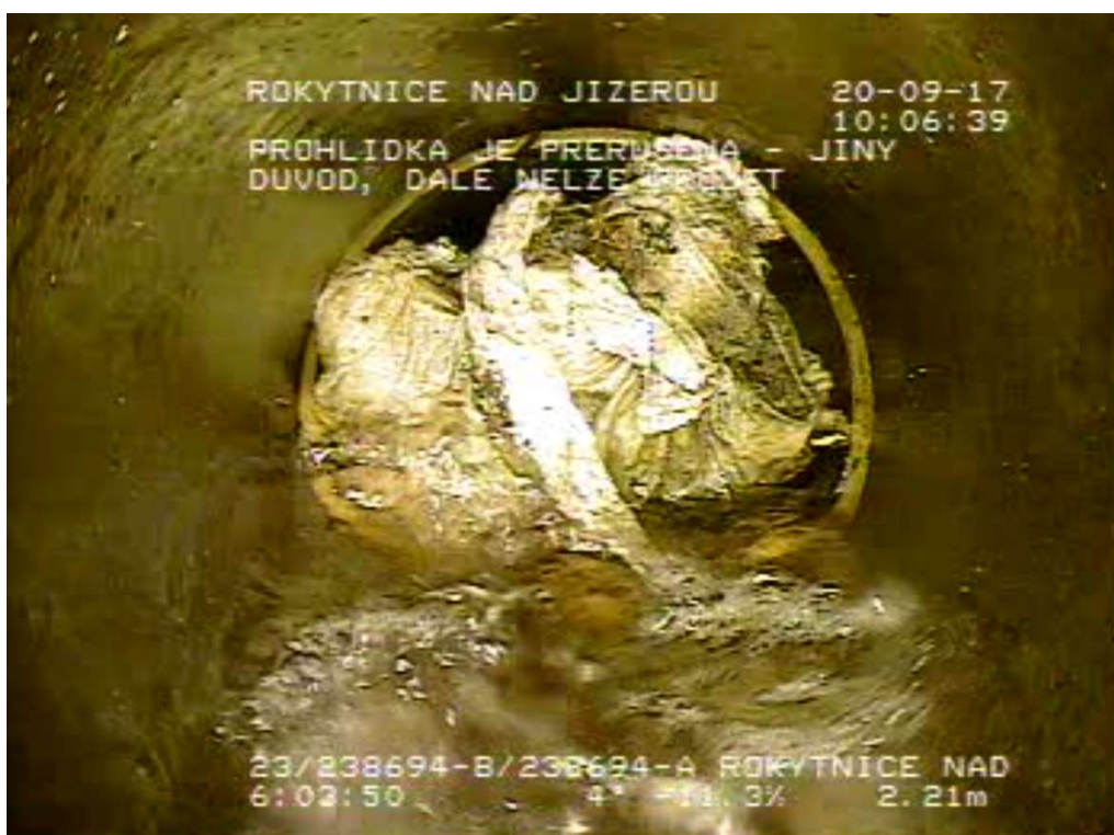
Obr. č. 24: 3 - Horní Rokytnice (1054869 - 1034765) - Konec prohlídky, ucpáno. - Rokytnice nad Jizerou
